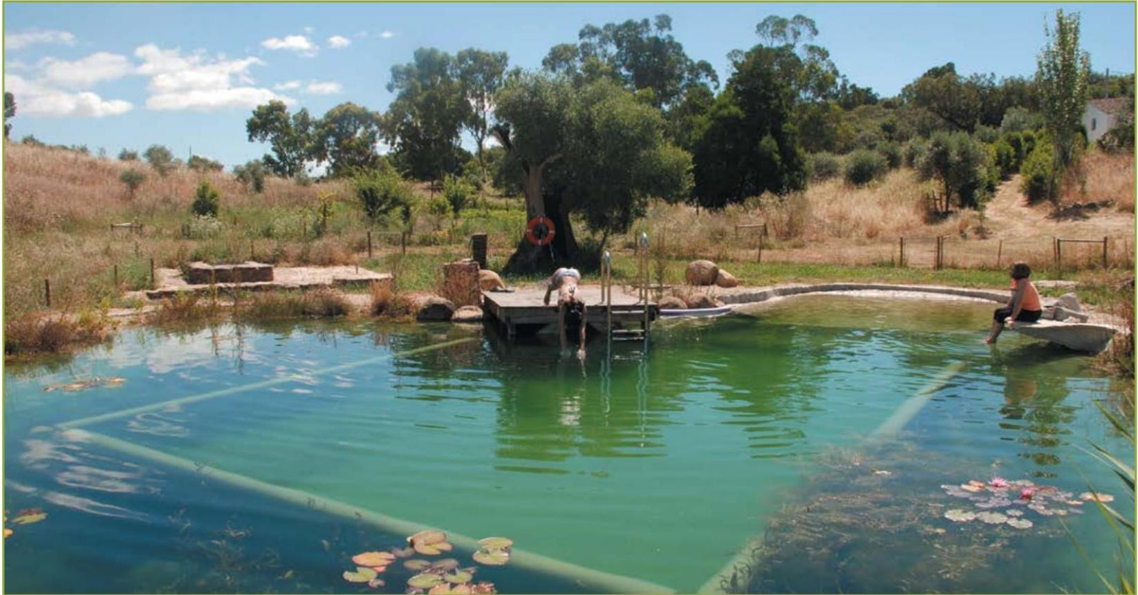
*Cette baignade ne présente pas de filtre ou de recirculation active de l'eau. Les eaux de surface sont reprises par skimmer (non visible sur la photo). Une zone importante de plantes subaquatiques, bien visibles sur la photo, traduit un type 2 : cette zone est nécessaire pour traiter l'eau et absorber le phosphore.*
